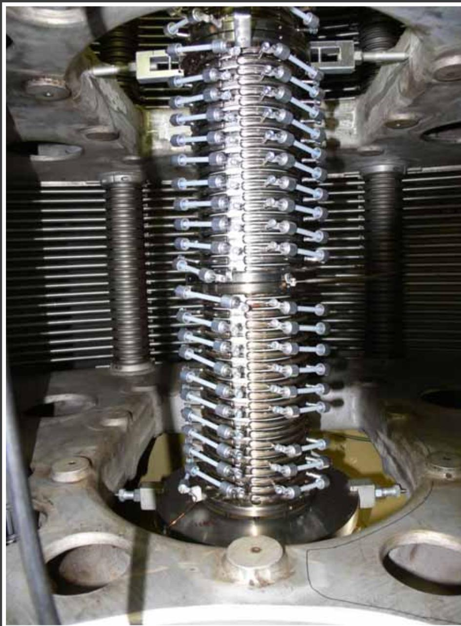
加速管 抵抗取付 & 新型加速管 (平成13 - 14年)
